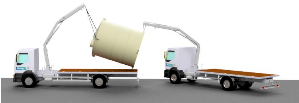
Figura 1 – içamento do reservatório.
