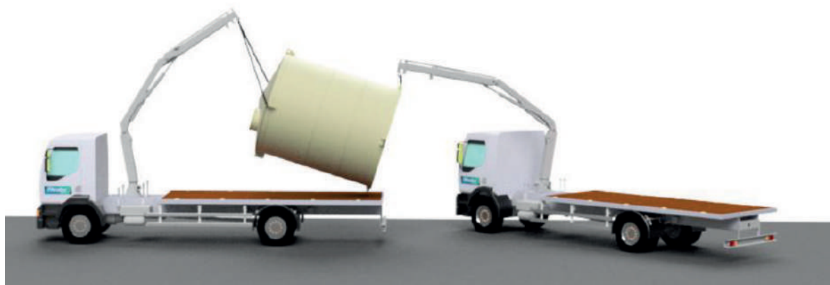
Figura 1 - Içamento do reservatório
