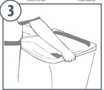
c) Posicione o tanque em nível, no local deseiado marque com um lápis os orifícios onde serão colocados os parafusos
